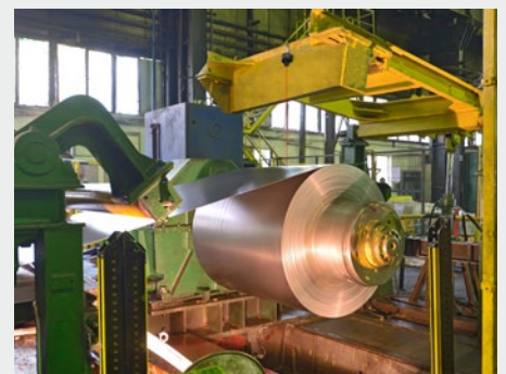
Erfassung von Coildurchmessern
