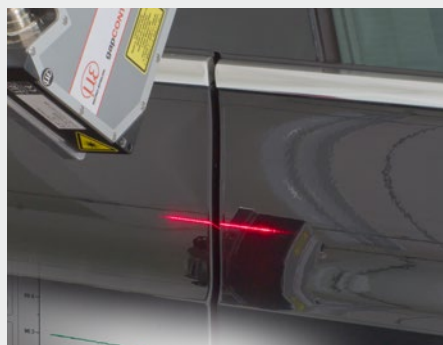
Spalt-/Bündigkeitsmessung an Karosserieteilen
