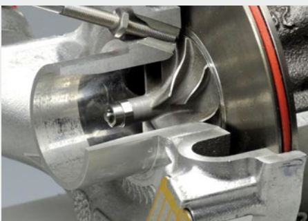
Drehzahlmessung von Turboladern
