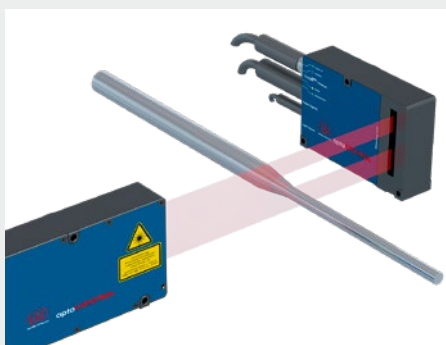
Durchmessermessung an konischen Verengungen
