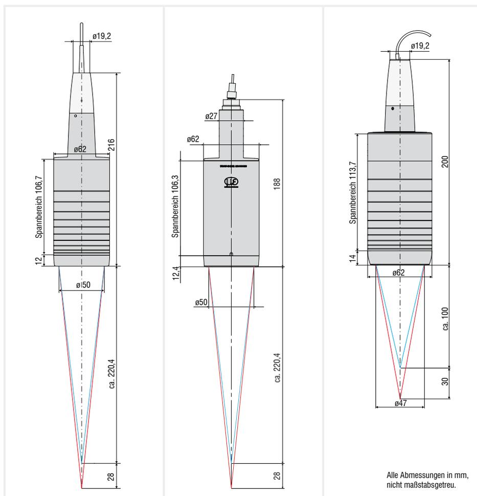
Alle Abmessungen in mm,
