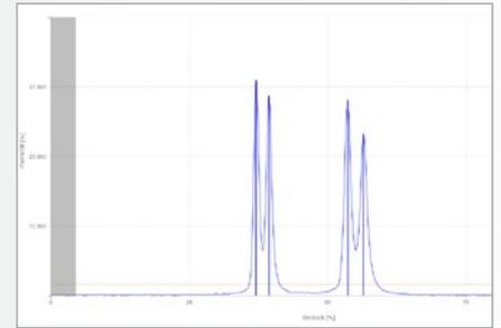
Signal bei Mehrschicht-Dickenmessung mit max. 6 Peaks
